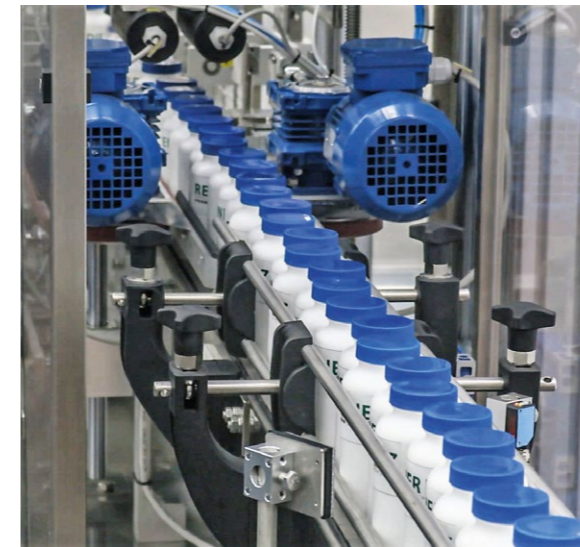
Vollautomatisch: Die Sleeveranlage kann die Verkaufseinheiten einschweißen und verpacken.
